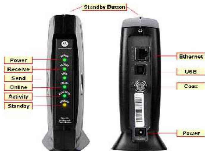
Fig. 5. Konektorët dhe indikatorët në modemin kabllor
